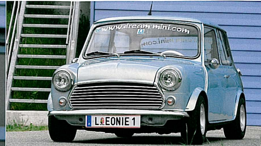
rechts: Das HiLo-Fahrwerk wurde weit abgesenkt
