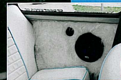
Eingebettet in Langhaarfilz – die hinteren SPL-Lautsprecher
